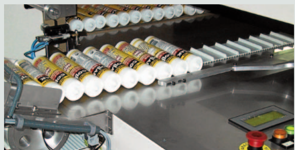
Encajado de envases cilíndricos a 9.000 piezas/hora
